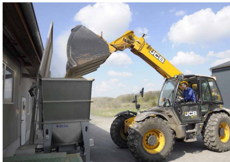
Die Anlage wird einmal täglich mit dem Teleskoplader befüllt.
